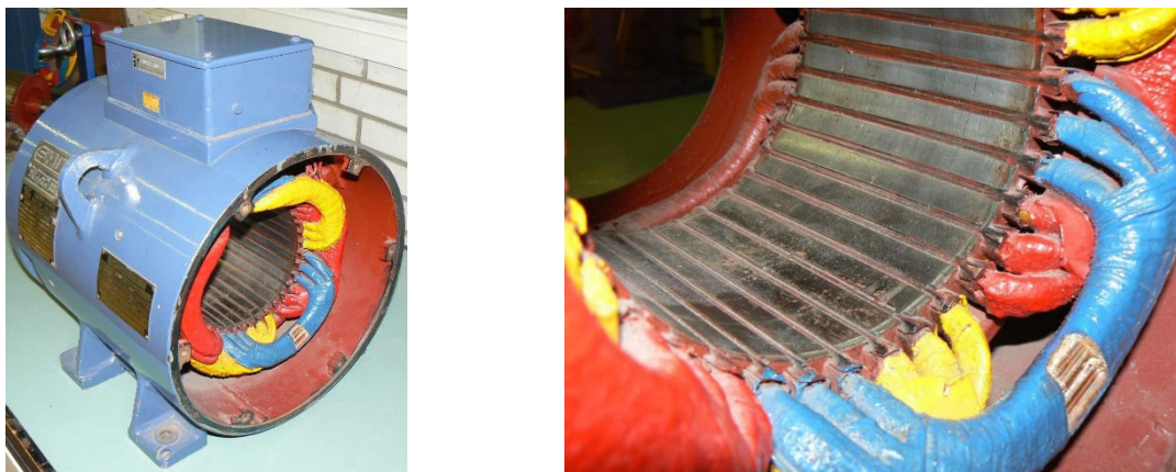
Stator asinhronog motora sa uloženim trofaznim jednoslojnim namotajem. Bojom su predočeni različiti fazni namotaji.
