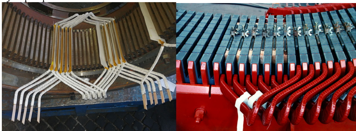
Slika 2.13. Ulaganje štapne sekcije u žlebove statora
