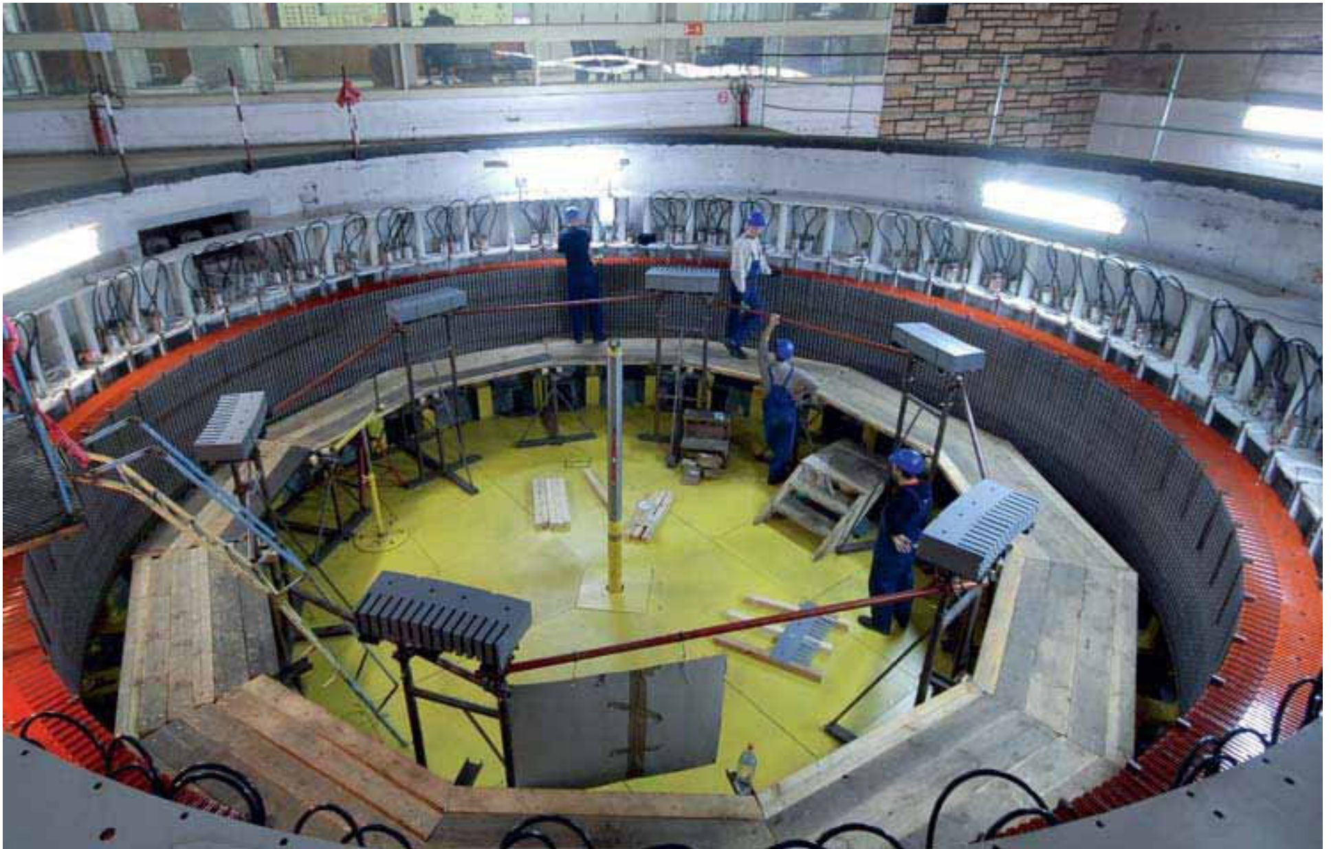
Slaganje limova magnetnog kola statora sinhronog hidrogenatora. Magnetno kolo većih mašina izrađuje se od segmenata.
