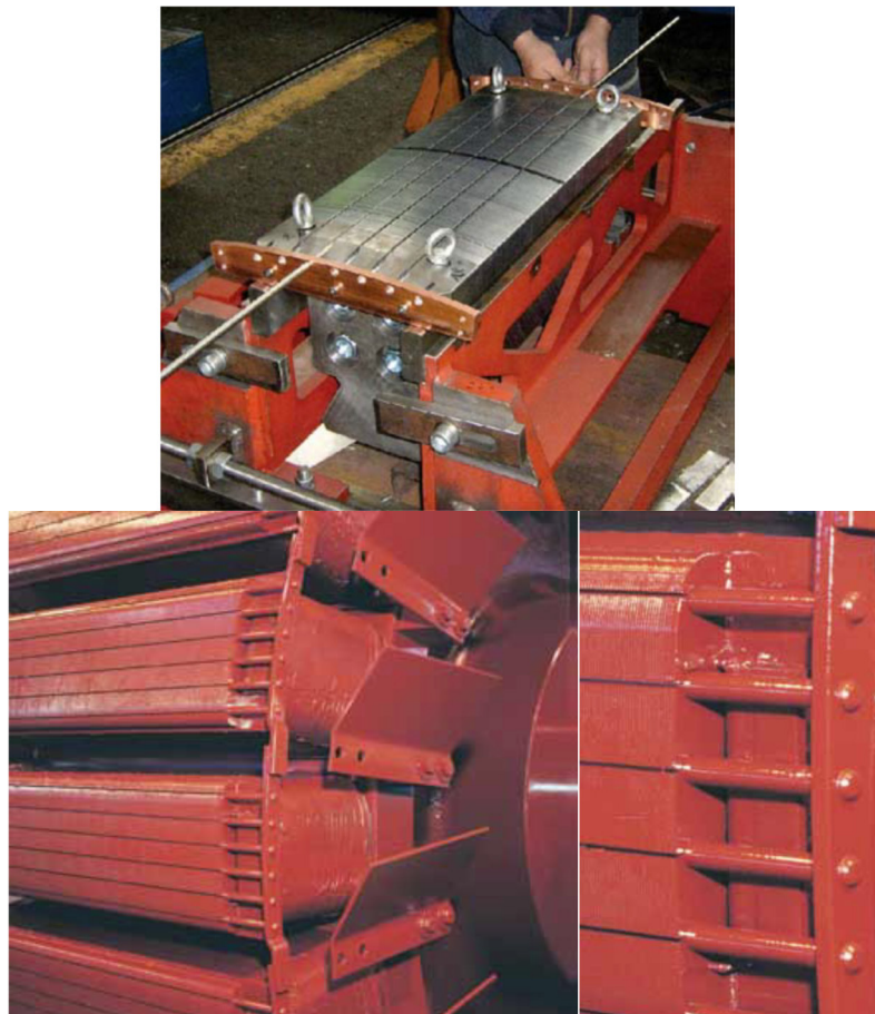
Slika 1.15. Amortizacioni namotaj i detalj kratkospojnog prstena.
