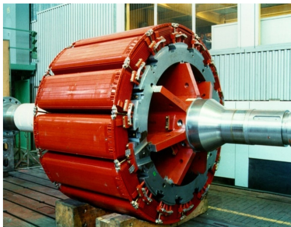
Slika 1.14. Rotor mašine sa istaknutim polovima.
