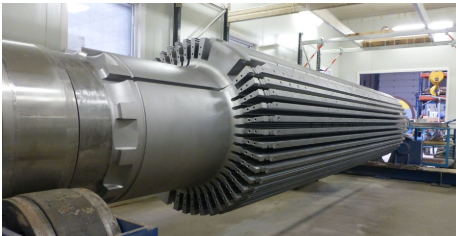
Slika 4.7. Ožlebljen dvopolni cilindrični rotor sinhronne mašine.
