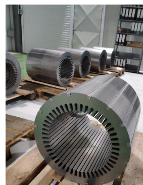
Slika 4.4. Magnetno kolo stator. Jasno se vide zupci, žlebovi i jaram. U žlebove će biti smešten trofazni namotaj.
