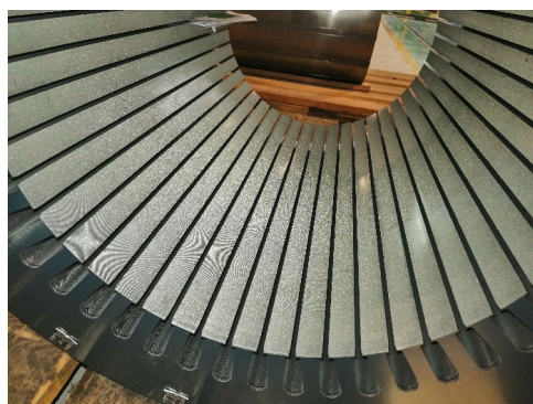
Slika 4.4. Magnetno kolo stator. Jasno se vide zupci, žlebovi i jaram. U žlebove će biti smešten trofazni namotaj.
