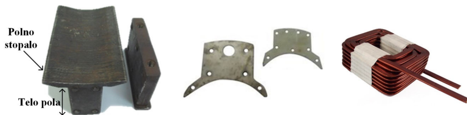
Slika 6.4. Polni nastavci, feromagnetni limovi i namotaj pobude.
