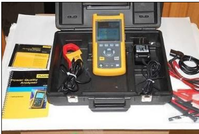
Slika 117: Merni uređaj FLUKE 43 B sa dodatnom opremom i dokumentacijom
