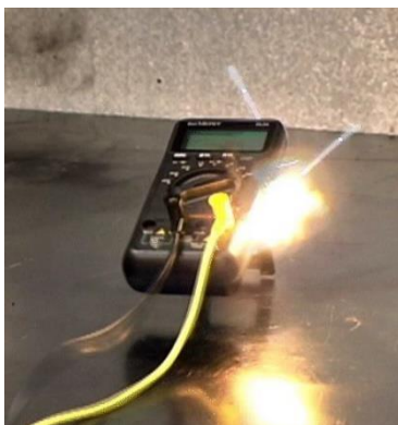
Slika 76: Pojava električnog luka na mernom uređaju
