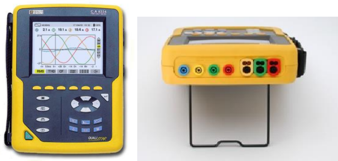
Slika 79: Izgled AKVEE C.A 8332B / C.A 8334B sa strujnim i naponskim priključcima
